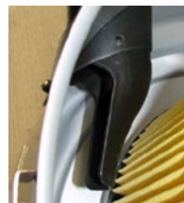
Bild 4. Der Staubablenker lenkt die verschmutzte Trägerluft vom Filter weg, das verlängert die Filterlebensdauer.
