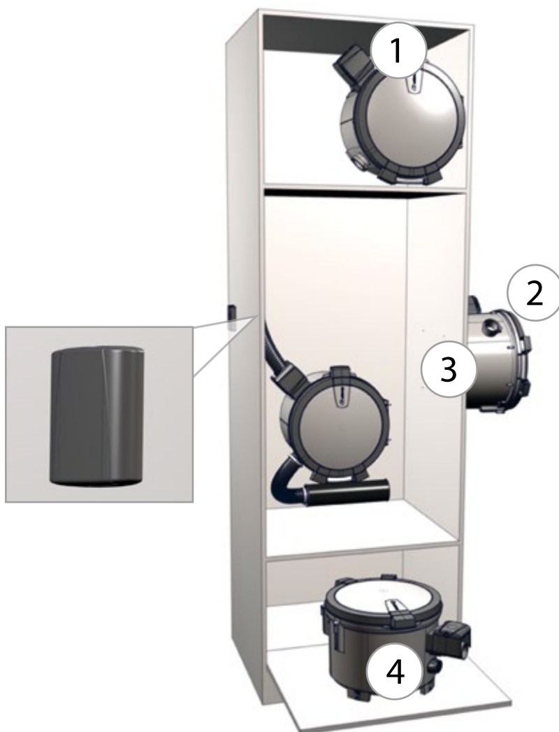
Bild 13. Soll die Zentraleinheit in einen Schrank eingebaut werden, so empfehlen wir, dass die Saugdose außerhalb des Schrankes platziert wird, damit die Schranktür nicht jedes mal zum Saugen geöffnet werden muss.
