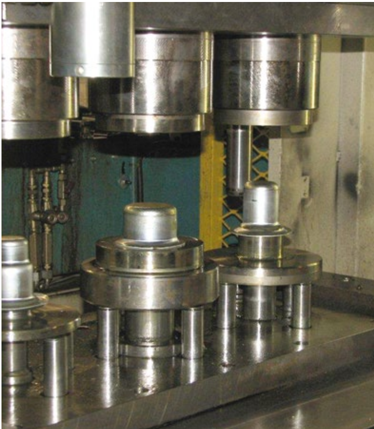
Bild 1. Die Tiefziehtechnik hat den Vorteil, dass die Gehäuse luftdicht sind und eine nahtlose Oberfläche besitzen.
