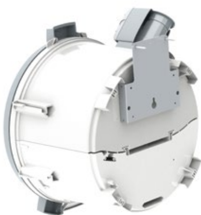
Bild 15. Das DUO Zentralgerät hat eine stabile Wandmontageplatte, die viele Installationsmöglichkeiten bietet. Diese Montagekonsole bietet eine feste Verbindung mit der Wand. Der DUO kann auch ohne Wandmontageplatte durch Schraublöcher am Boden des Gerätes auf einen Regalboden geschraubt werden.
