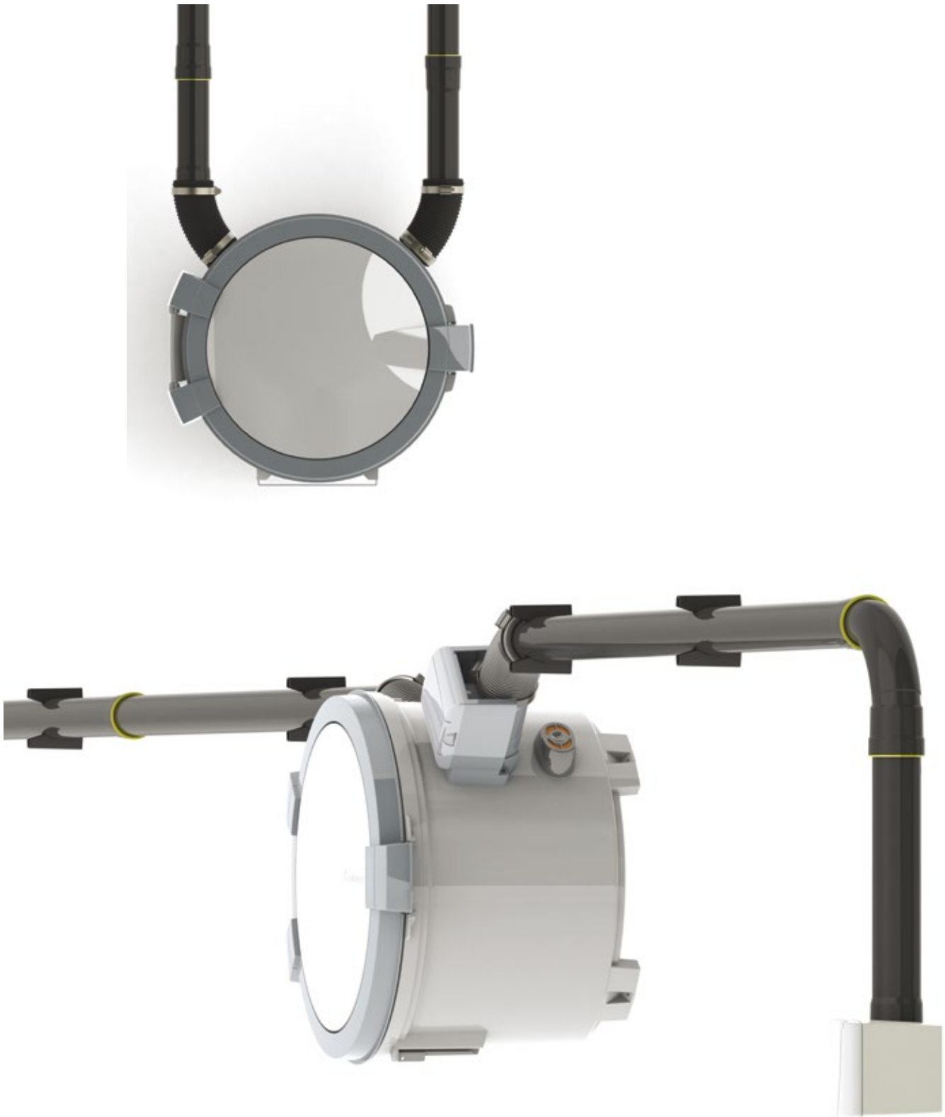
Bild 14. . Längsseits des DUO kann man eine eigene Saugdose befestigen, von welcher die Saugrohre dann ganz normal von einer Saugdose zur nächsten gezogen werden können.
