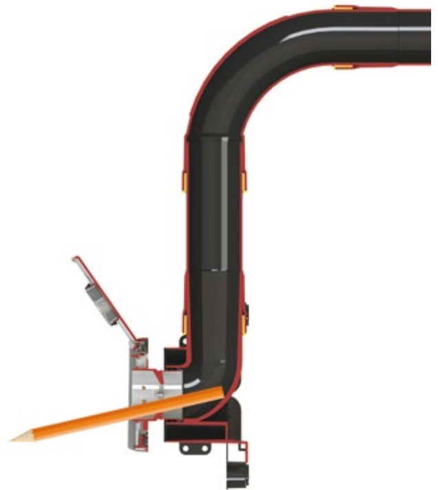
Bild 6. Direkt hinter dem Fangkreuz befindet sich der schärfste Bogen, welcher das Eindringen von Bleistiften und anderen stabförmigen Teilen verhindert.
