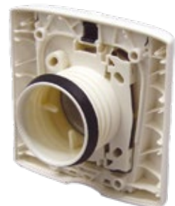
Bild 4. Auf der Rückseite befindet sich ein Saugstutzen mit V-Dichtung welcher gemäß der Wanddicke abgelängt werden kann. Ist der Weg zum Montagebauteil länger als dieser Stutzen, so kann eine spezielle Verlängerung verwendet werden.
