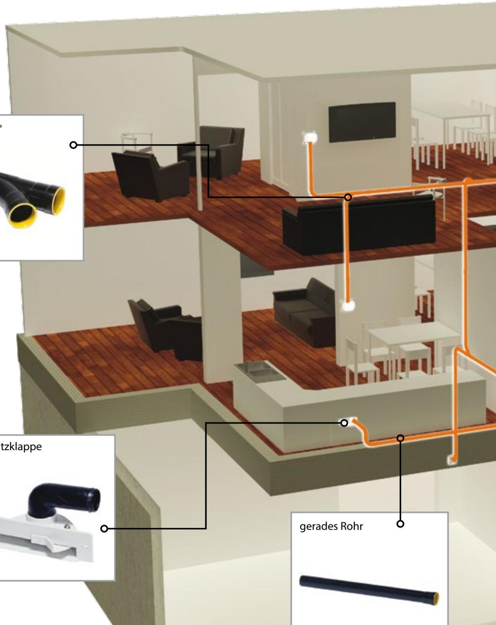
Es ist sehr einfach, eine ALLAWAY Staubsaugeranlage auszulegen. Das System besteht aus einer Zentraleinheit, der Spezialverrohrung, den Saugdosen und dem Reinigungsset. Alle Teile des Systems arbeiten, perfekt aufeinander abgestimmt, zusammen – das sichert einen langlebigen und verlässlichen Betrieb. ALLAWAY ist der einzige Zentralstaubsauger-Hersteller der ein eigenes integriertes System anbietet. Das ALLAWAY Zentral-Staubsaug-System wird üblicherweise während der Bauphase
