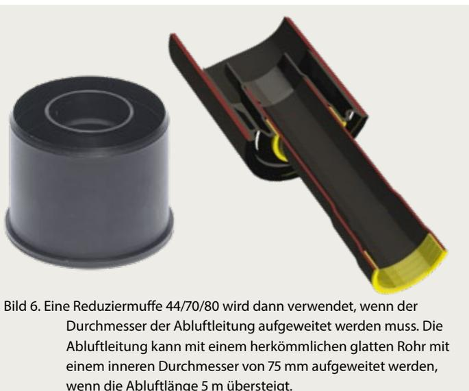
Bild 6. Eine Reduziermuffe 44/70/80 wird dann verwendet, wenn der Durchmesser der Abluftleitung aufgeweitet werden muss. Die Abluftleitung kann mit einem herkömmlichen glatten Rohr mit einem inneren Durchmesser von 75 mm aufgeweitet werden, wenn die Abluftlänge 5 m übersteigt.
