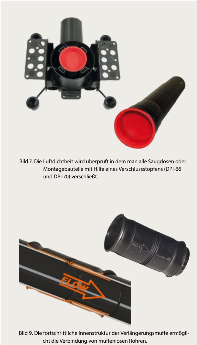
Bild 7. Die Luftdichtheit wird überprüft in dem man alle Saugdosen oder Montagebauteile mit Hilfe eines Verschlussstopfens (DPI-66 und DPI-70) verschließt.
