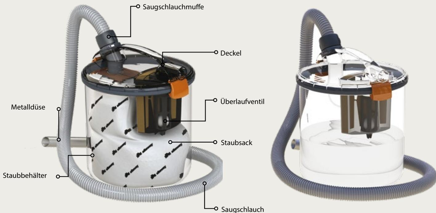
Bild 1. Der Vorabscheider ist zum Saugen von Wasser, Sand oder andere Arten von groben Schmutz geeignet. Beim Saugen von kalter Asche oder sonstigen Feinstaub muss ein Staubbeutel in den Vorabscheider eingelegt werden (linkes Bild). Beim Saugen von Wasser muss dieser Staubbeutel entfernt werden (rechtes Bild).
